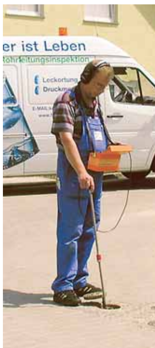
Mit moderner Technik werden Leckagen aufgespürt und Abwasserkanäle per Kamera inspiziert.
